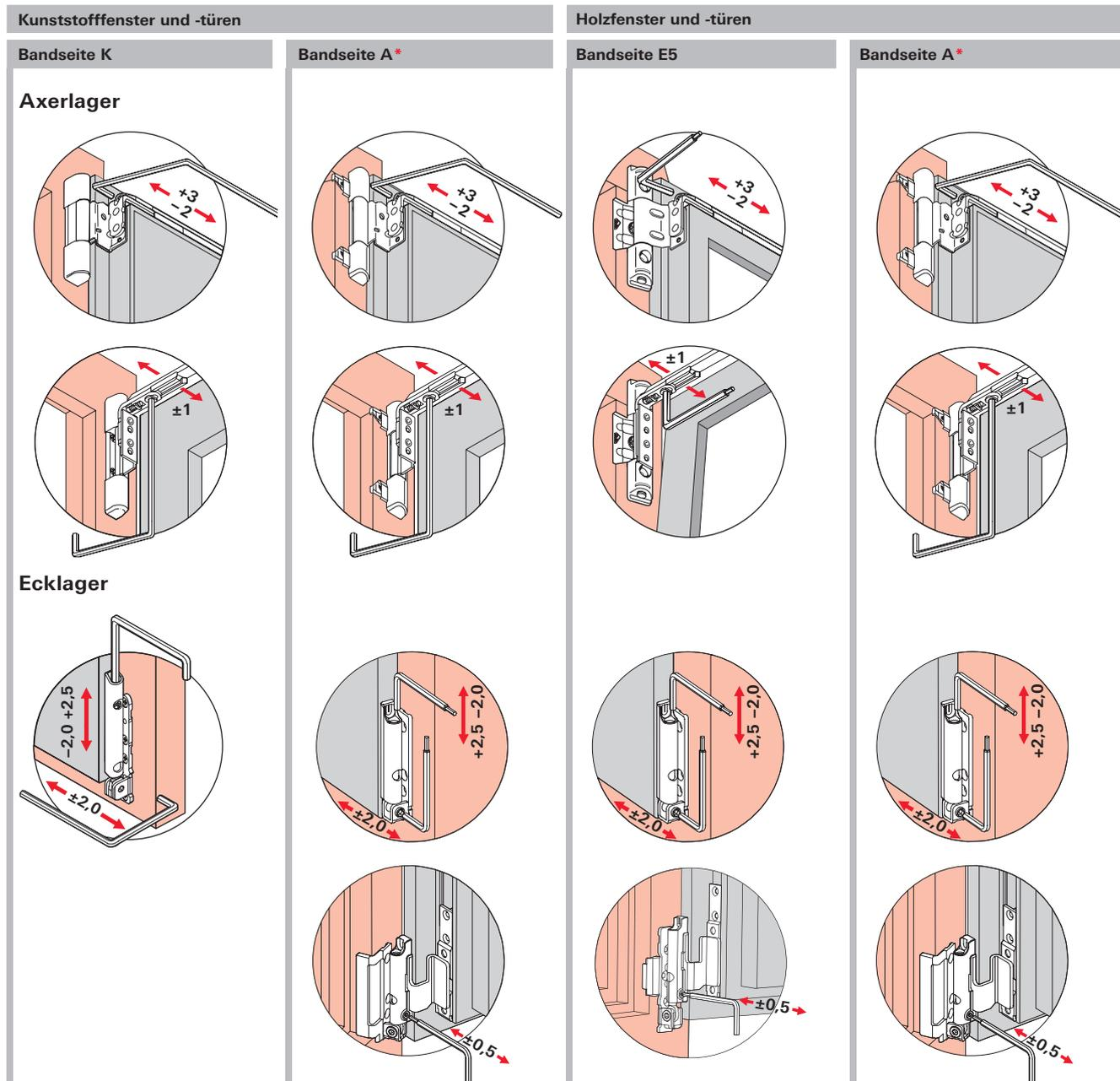
\* Beim Einsatz von Abdeckkappen (Axerlager/Ecklager) und Eckbandsicherung ändern sich die angegebenen Verstellmaße.
