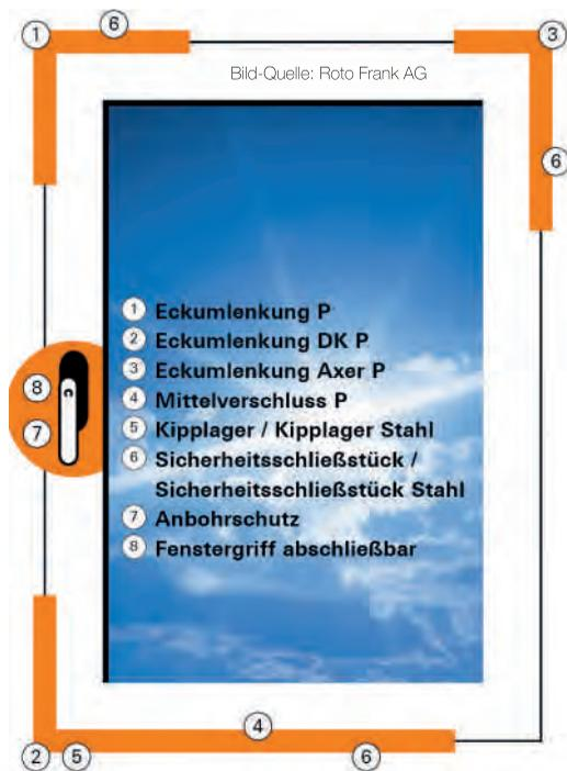
In der Widerstandsklasse RC1 / RC1N\* leistet der Beschlag ganze Arbeit gegen Versuche, das Fenster aufzubrechen.
