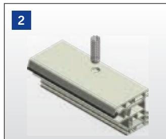
Siebhülse einschieben und bündig am Profil abschneiden.
