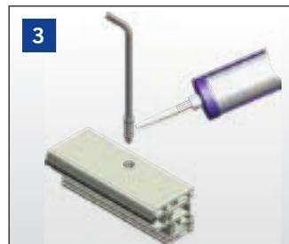
Profildübel auf Spezialmontageschlüssel aufstecken und mit Kleber benetzen.
