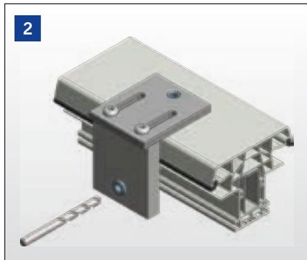
Aufsetzen der Bohrvorrichtung (Der Kopf der Bohrbuchse dient zur Fixierung der Positionslage am Fensterprofil).
