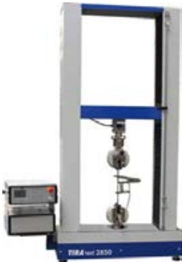
Zugprüfmaschine für Auszugversuche an Fensterprofilen
