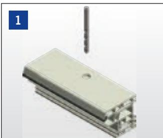
Blendrahmen bzw. T-Pfosten mit Bohrer D-8 mm vorbohren (Bohrtiefe beachten).
