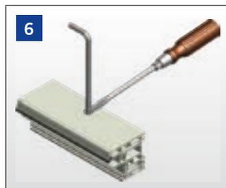
Nach dem letzten Einbringen den Spezialmontageschlüssel entfernen (mit Werkzeug gegenhalten).
